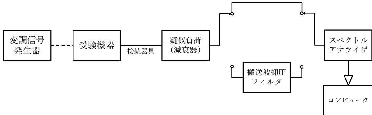
接続器具は、各種導波管変換器等である。
